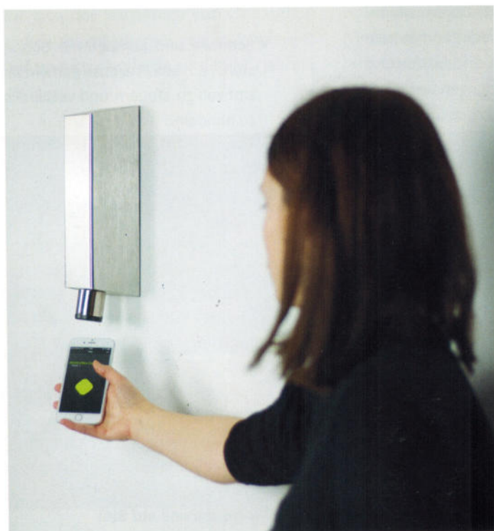
Einfach per Smartphone-App öffnen, und der KIWI Safe gibt hinterlegte Schlüssel frei.
