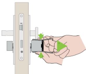
3.2.4 Die nun entsperreten Hüllenverriegelungsstifte des Türknaufs mit dem Batteriewechselwerkzeug oder einer Büroklammer gleichzeitig eindrücken und die Türknaufhülle kräftig (!) abziehen.
