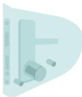
3. Entnehmen Sie die leere Batterie und setzen eine neue ein. Achten Sie dabei auf die Polarität.
